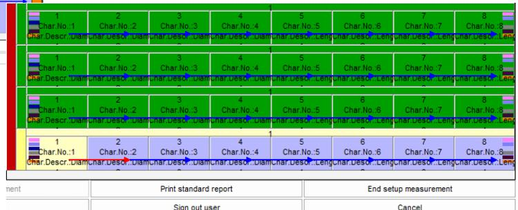
Nach der Auswahl der Schaltfläche zum Beenden der Sondermessung erfolgt der Wechsel zu dem normalen Messablauf. Entsprechend der Konfiguration wird die Abfrage zum Verwerfen der erfassten Sondermessung ausgegeben.
