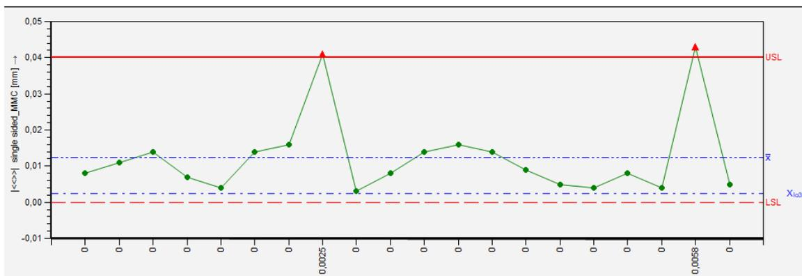
Hier wird das normierte Merkmal mit der theoretischen Toleranzausnutzungen (Y-Achse) dargestellt.
